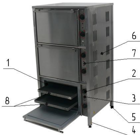
Рис.1. Загальний вигляд шафи: 1 - камера жарова; 2 - датчик-реле температури; 3 - лампа сигнальна; 4 - кронштейн захисного з'єднання (заземлення); 5 - опора регулююча; 6 - бокова панель; 7 - панель управління; 8 - деко.
